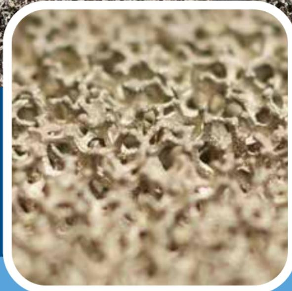
Anwendungen wie zum Beispiel Energieabsorption, Schutzstrukturen, Filtration, Dämpfung oder Wärme- management. Trotz seines sehr geringen Gewichts verfügt NiProFoam™ über hervorragende Druckfestig- keitswerte und ein duktiles, fragmentfreies Verfor- mungsverhalten – selbst unter extremen Bedingungen.
